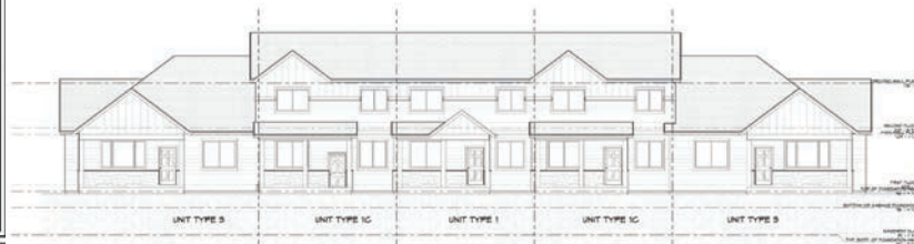
1 FRONT ELEVATION SCALE: 1/8" = 1'-0"
